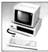
tramos ainda o mais novo projeto da empresa: o protótipo de uma máquina compatível com o AT da IBM. O AT tem processador 8026 e memória de 256 Kb a 3 Mb
